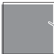
Les positions de coupe et d'impression sont désalignées.
