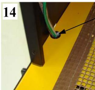
Tirez doucement sur les fils pour retirer tout excès de câble sous le convoyeur.
