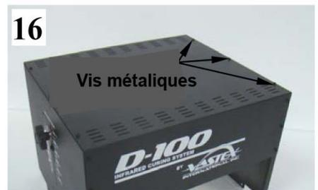
**Installez le capot supérieur après avoir fait les raccordements électriques**
