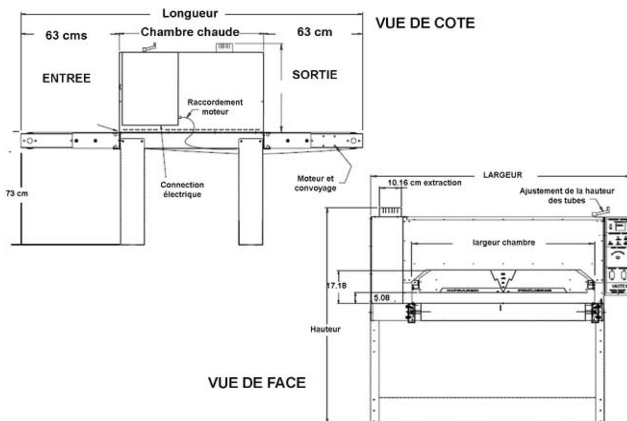
Le Tunnel ECONORED II est un tunnel à déplacement électrique et à séchage infrarouge. Ces différents modules lui permettent d'être totalement évolutif jusqu'à une puissance de séchage de 500 pièces par heure.
