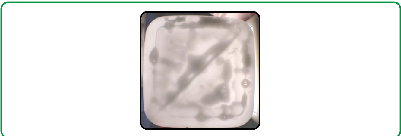
Keine Ablagerungen mehr sichtbar, nur Schaum: OK
