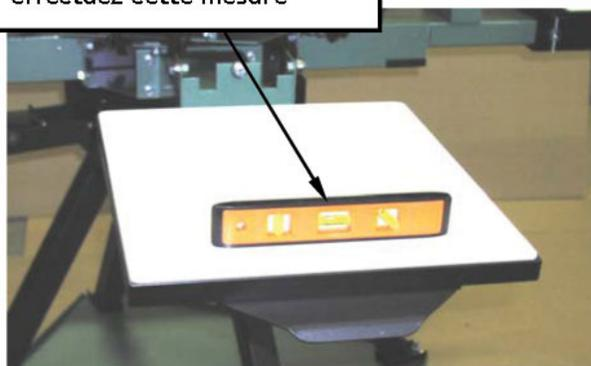
**Note : Contrôler le niveau une nouvelle fois dans toutes les directions après les réglages. Une fois la mise a niveau correctement effectuée serrez les vis.**
