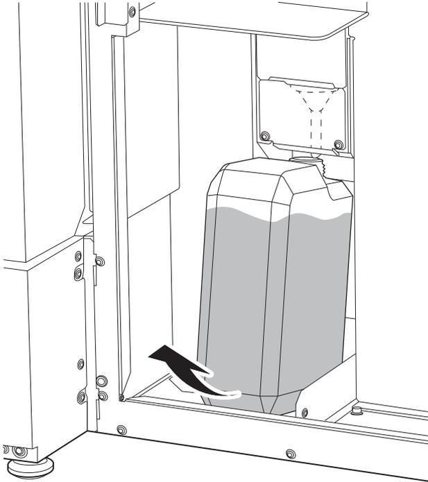
3. Fixez rapidement la bouteille de vidange vidée à la machine à nouveau.
