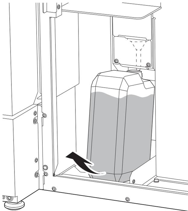
9. Fixez rapidement la bouteille de vidange vidée à la machine à nouveau.
